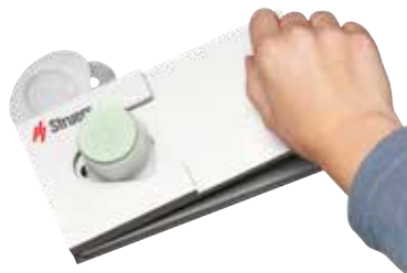
Wupty 可轻松地由 FixiForm 中挤压出镶件。
